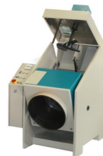
Положение для выгрузки смеси и очистки
